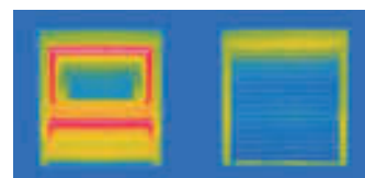
Wärmebild ohne/mit Rollladen: Die Luftschicht zwischen Fenster und Rollladen ist ein guter Wärmespeicher.
